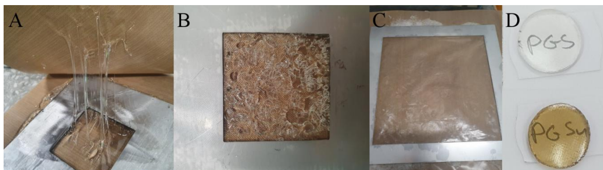
Rysunek 49 Zdjęcia produktów prasowania PGS, A – nieusieciowany, B – usieciowany z defektami, C – sieciowany w warunkach optymalnych, D – krążki wycięte z folii otrzymanych w warunkach optymalnych
